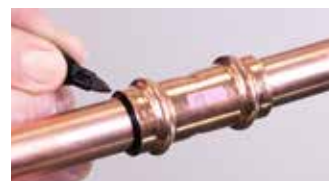
7B. Sinon, insérez le tube jusqu'à la butée du raccord et marquez-le.
