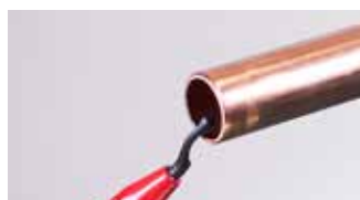
3. Utilisez un ébavureur de type crayon sur les bords internes
