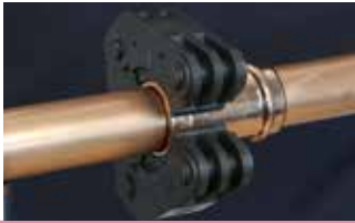
1. Mettre en place l'anneau de sertissage
