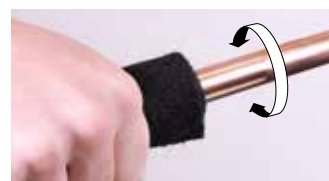
4. Nettoyez l'extrémité du tube
